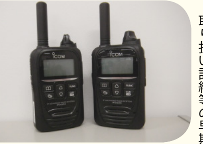
震災の教訓を踏まえ、先行して市消防局に導入されたIP無線機
