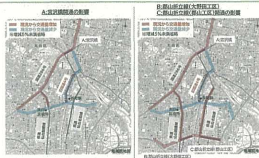
A: 宮沢橋の開通に伴い、国道286号方面の交通量が増加する。その後、B: 郡山折立線(大野田工区)、C: 郡山折立線(郡山工区)が開通すると、県道仙台館腰線・仙台名取線の交通量が微増する。
